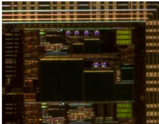
Abbildung 10: Der Equalizer auf dem gefertigten Chip
